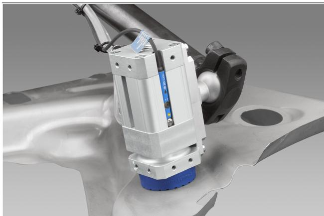
Ventosa magnetica SGM-HP per la movimentazione di lamiera grezza da costruzione
